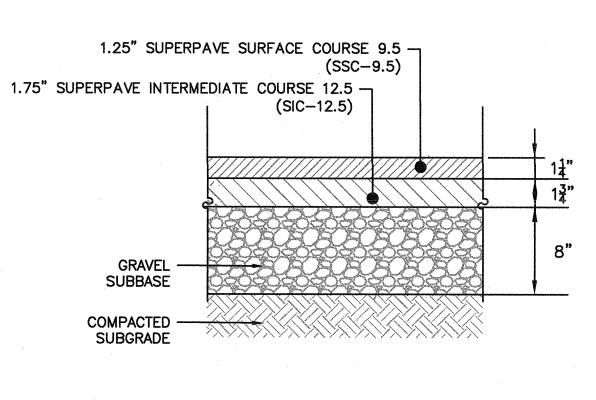
HOT MIX ASPHALT SIDEWALK NOT TO SCALE
