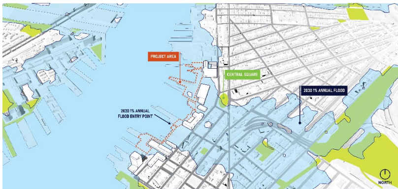
Figura 4. Conceptualización de la Ruta de Inundación Anual del 1% Proyectada para 2030 en la Costa de Border Street. Weston & Sampson, 2024.
