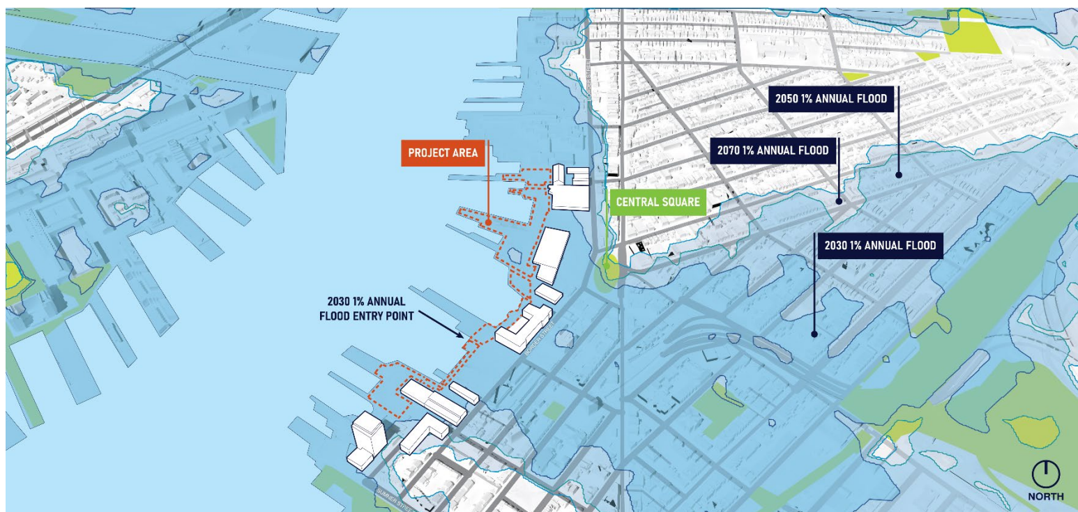
Figura 6. Conceptualización de la Ruta de Inundación Anual del 1% Proyectada para 2070 en la Costa de Border Street. Weston & Sampson, 2024.
