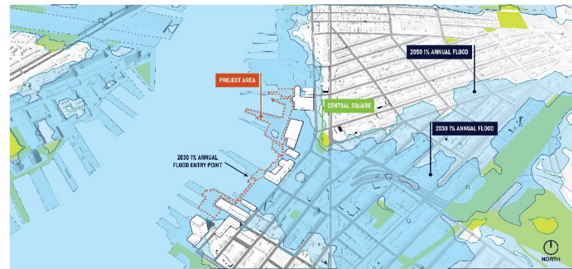
Figura 5. Conceptualización de la Ruta de Inundación Anual del 1% Proyectada para 2050 en la Costa de Border Street. Weston & Sampson, 2024.
