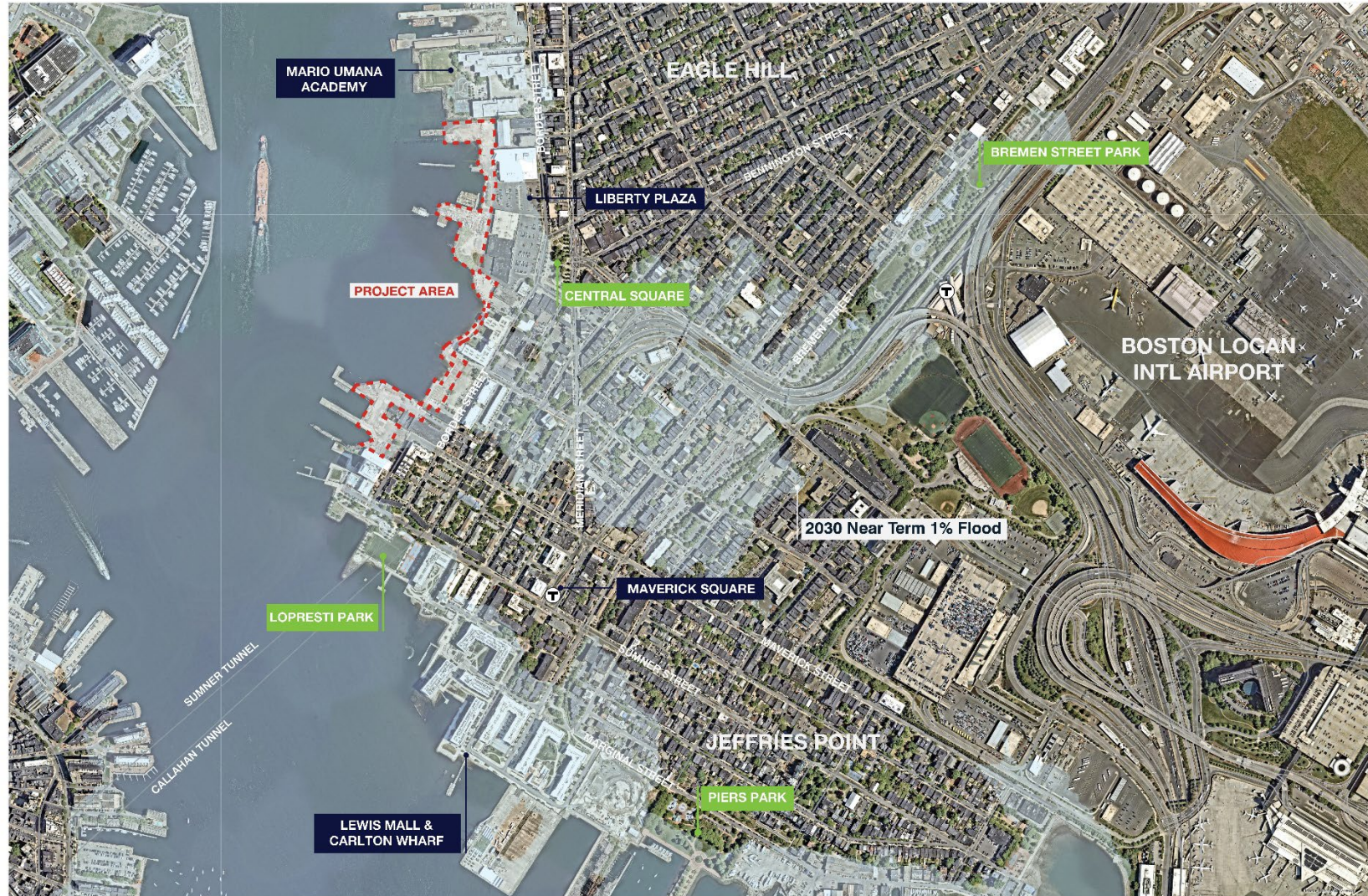
Figura 1. Vista aérea del área del Proyecto de Resiliencia de la Costa de Border Street, con inundaciones proyectadas durante una tormenta con una probabilidad anual del 1 % y un aumento del nivel del mar de 9 pulgadas, anticipado para el año 2030. Weston & Sampson, 2024.
