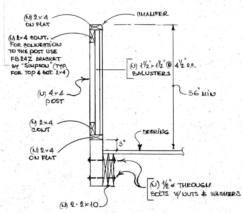
NEW TYPICAL GUARDRAILING DETAIL
